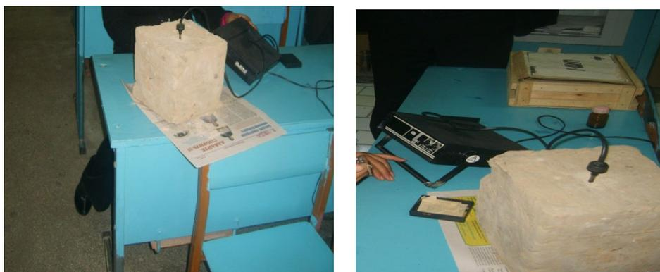
Рис.1. Определение теплопроводности с прибором ИТ-1.
