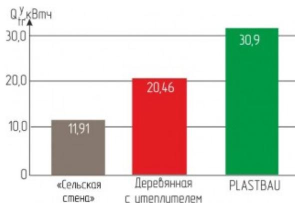
Рис. 4 Теплопотери в здании через  $1 \text{ м}^2$  стены за отопительный период, кВтч
