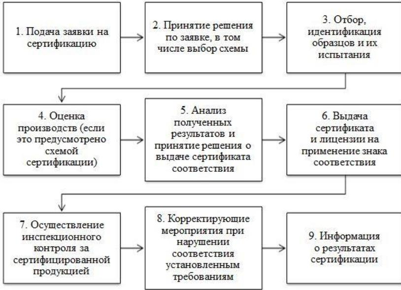
Рис. 4.12. Последовательность проведения процедуры сертификации продукции
