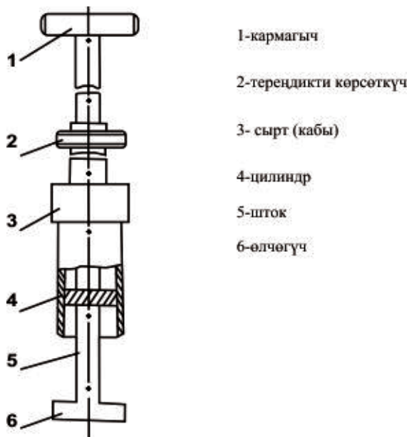
3.5 – сүрөт. Күпкөлөөчү суюктуктан үлгү алуу үчүн аспап
